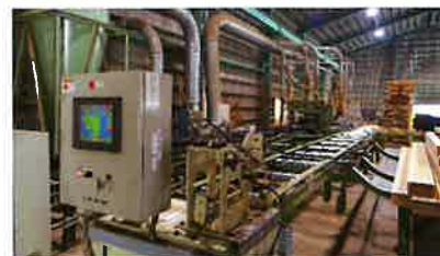
↑四面カンナ盤に直結したグレーディングマシンの含水分・強度を測ることが可能。この機械で等級区分による管理を行っています。
